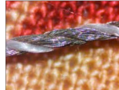
Abb. 1: Mikroskopische Aufnahme eines leitenden Nähgarns der Firma Amann. Für besseres Verständnis der Leifähigkeit bei gleichzeitiger Verarbeitbarkeit ist eine Visualisierung notwendig. Sowohl für Studierende als auch für Schüler\*innen würde die Besonderheit des Garnes sonst nicht mit freiem Auge sichtbar sein. © Paul Reza Klein
