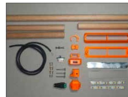
Abb. 4: Ein Lampenbausatz aus einer Kombination von 3D-Druckteilen, Holz und Elektronik. © Paul-Reza Klein
